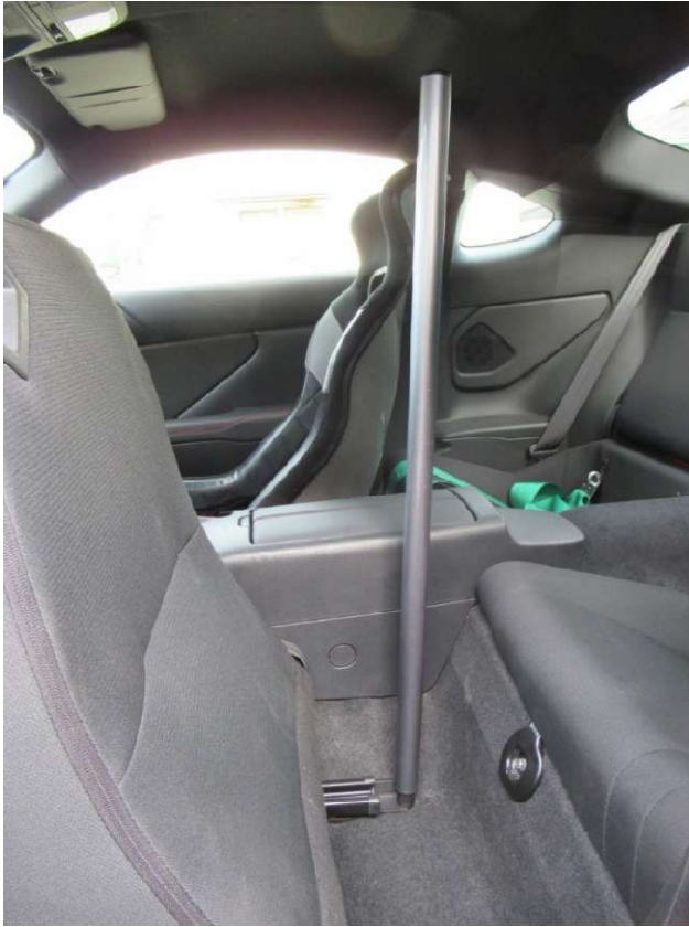
丸棒Aを右側のブラケットに取り付ける
