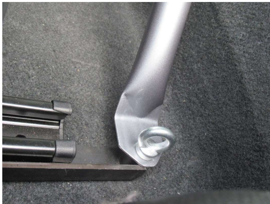
丸棒Bを左側のブラケットに付属のIボルトで取り付ける（手で締める程度で十分です）
